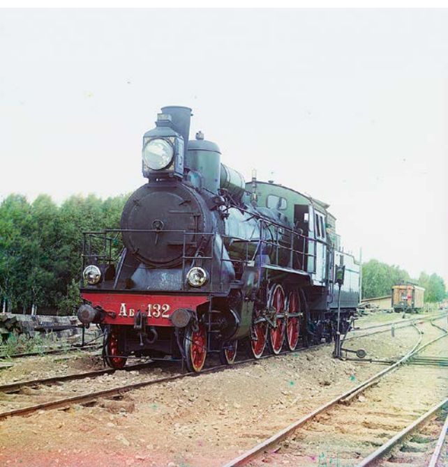
Паровой двигатель Компаунд с супернагревателем Шмидта. 1910 г.
